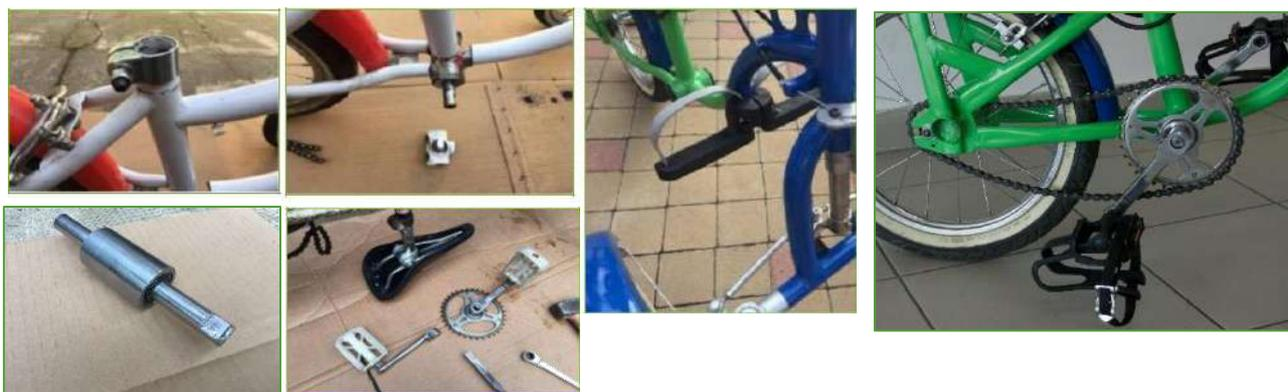
Il meccanismo dei pedali è stato recuperato da un altro modello di bici per bambino, che aveva già integrata la possibilità di sfilare i pedali. Il canotto (cilindro) è stato tagliato dall'altra bici e risaldato sul modello finale, in quanto non era possibile adattare i pedali al modello modificato per incompatibilità di dimensioni.
