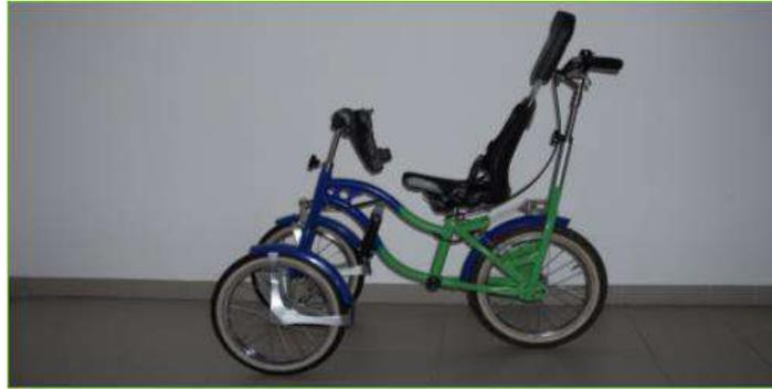
Il controllo dello sterzo avviene tramite cavi di rimando (quelli di uno scooter della Piaggio) che passano dentro il telaio per non intralciare il movimento del bambino. Davanti e dietro il tubo di sterzo è collegato a un sistema rotante per permettere la trasmissione del movimento dello sterzo.
