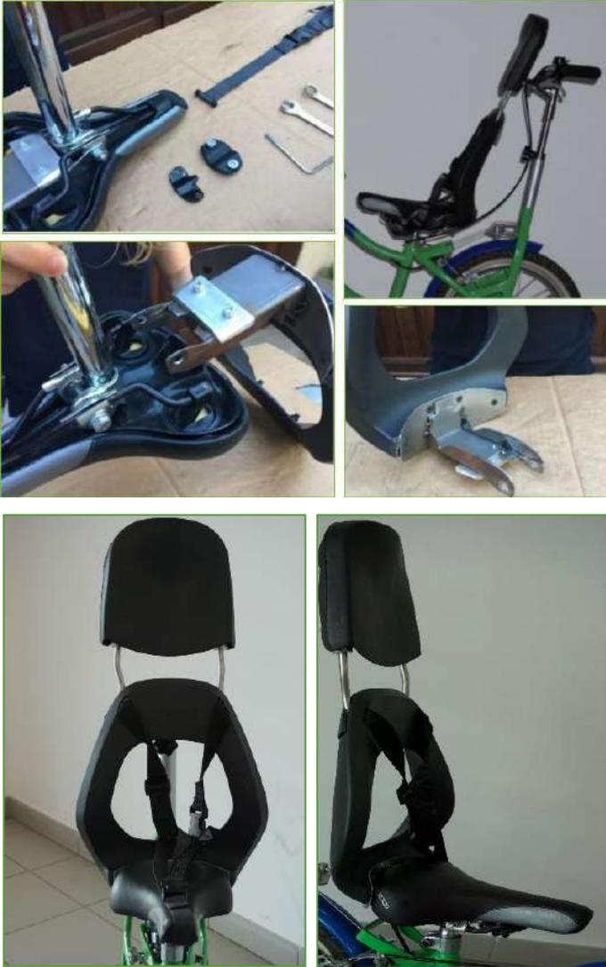
Il seggiolino ideato si basa quindi sull'unione di due sistemi già esistenti. Una prima parte comprende un normale sellino da bici, che si attacca al telaio della bici tramite il tubo portante. La seconda parte prevede un supporto per la schiena preso da un seggiolino porta-bimbi per bici. Quest'ultimo è integrato con un supporto per la testa recuperato dalla seduta seggiolino originale porta-bimbi.
