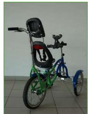
Il supporto del manubrio nella parte posteriore (la seconda forcella) deriva dal telaio di un'altra bici opportunamente tagliato e risaldato sul modello definitivo. Lo spostamento del manubrio è un'operazione che richiede poco tempo in quanto basta sfilare il bullone e reinsertirlo a spostamento avvenuto, ed è quindi facilmente realizzabile da parte dei genitori di Simone.
